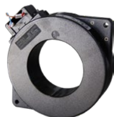
Rilevatore di corrente residua. Importante: La calza di messa a terra della schermatura del cavo deve essere isolata e ripassata dentro il foro del T.A. e del toroide.
